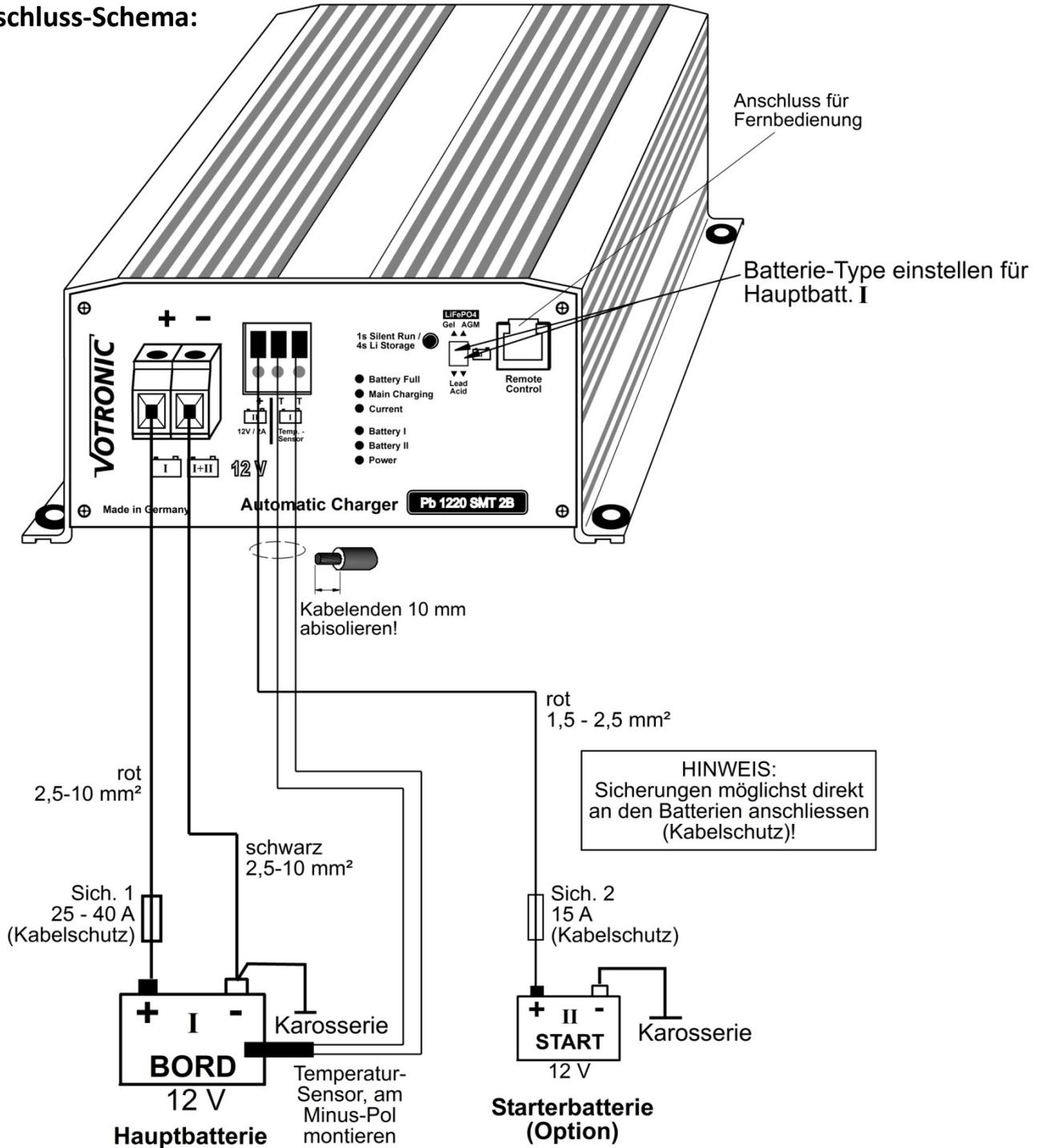
*Hinweis: Das Gerät arbeitet aus Sicherheitsgründen bei LiFePO4-Batterien nur mit angeschlossenem Temperatur-Sensor! Sensor am Minus-Pol der Batterie anschrauben.*
